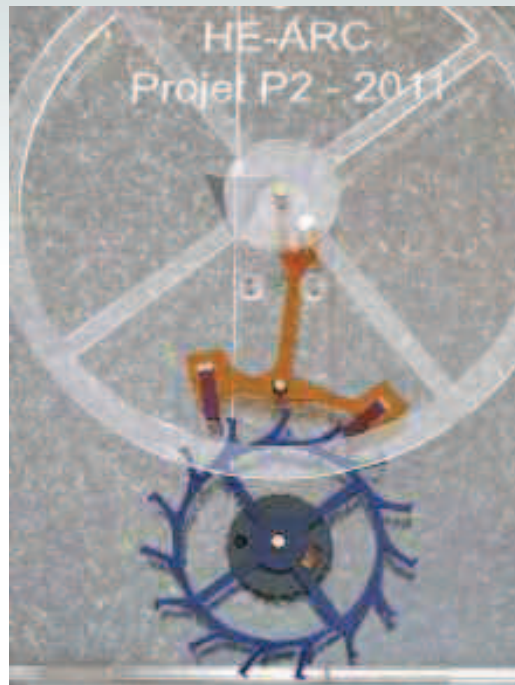
Im Rahmen eines Projekts an der Haute Ecole Arc in Le Locle entstandene Hemmung für das Uhrwerk „Openmovement“.
