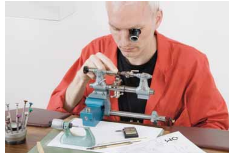
Au comité d'Openmovement siègent Philipp Wittwer, Roman Winiger, Urs Gottscheu et Mark Wyss (photo de gauche, de g. à d.). La création de mouvements passe par le travail sur les spiraux et le pivotage. SP-YVONNE DICKOPF
